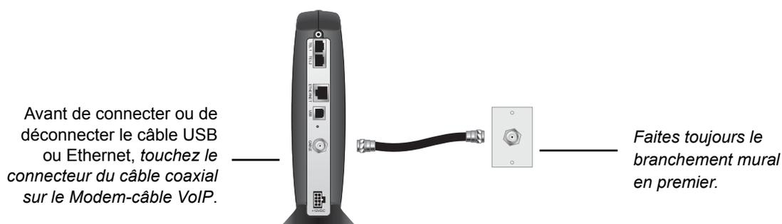
Pour éviter la surchauffe du Modem-câble VoIP, n'obstruez pas les orifices de ventilation situés sur les côtés.
